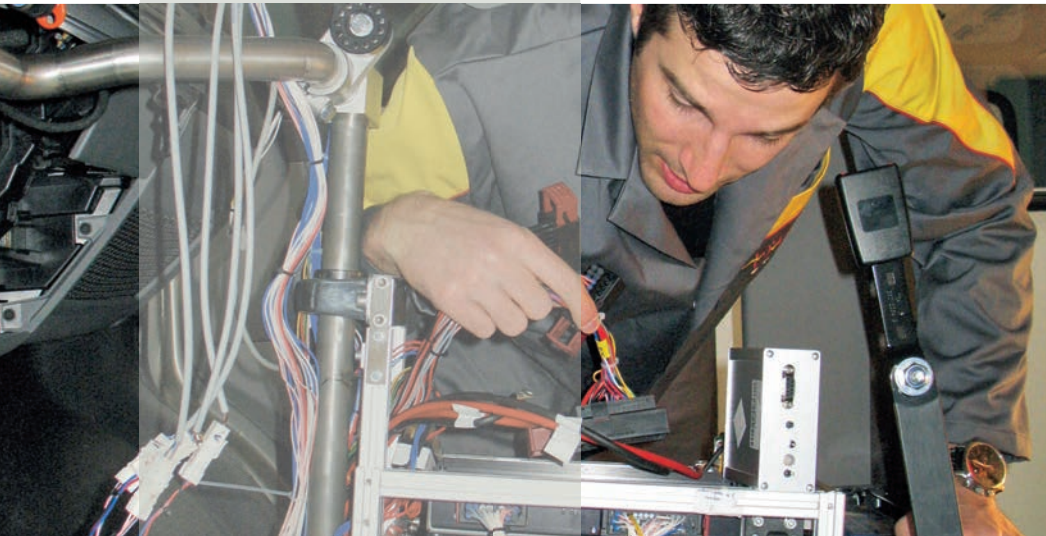
Il sistema elettrico-elettronico attiva due motori che portano lo sterzo nei relativi angoli di sterzata.
