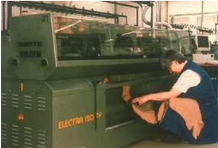
Quelle: Firma Schaub, Flachstrickmaschine
